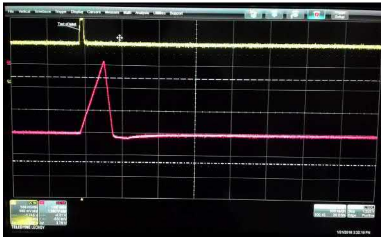
Figura 2.6: Scarica veloce effettuata tramite l’attivazione del circuito di reset. Le scale di tensione sono pari a 500\text{ mV/div} per il segnale del trigger, 1\text{ V/div} per il segnale della carica, mentre quella dei tempi è posta a 500\text{ ns/div} .
