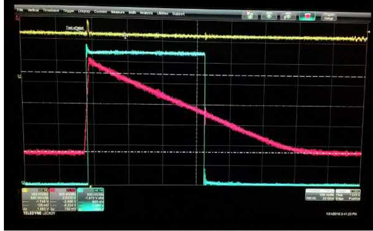
Figura 2.7: Misura con oscilloscopio dei segnali presenti sulla slave. In giallo il segnale di Global Trigger ( 500\text{ mV/div} ), in rosa la tensione ai capi della capacità di espansione ( 200\text{ mV/div} ), in azzurro il segnale generato dal comparatore ( 500\text{ mV/div} ). La scala temporale è di 500\text{ ns/div} .
