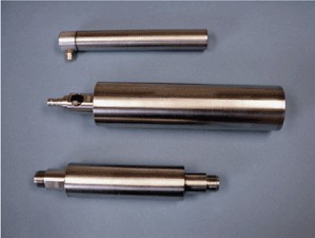
Figura 4. Contatori He3 proporzionali della St. Gobain.
