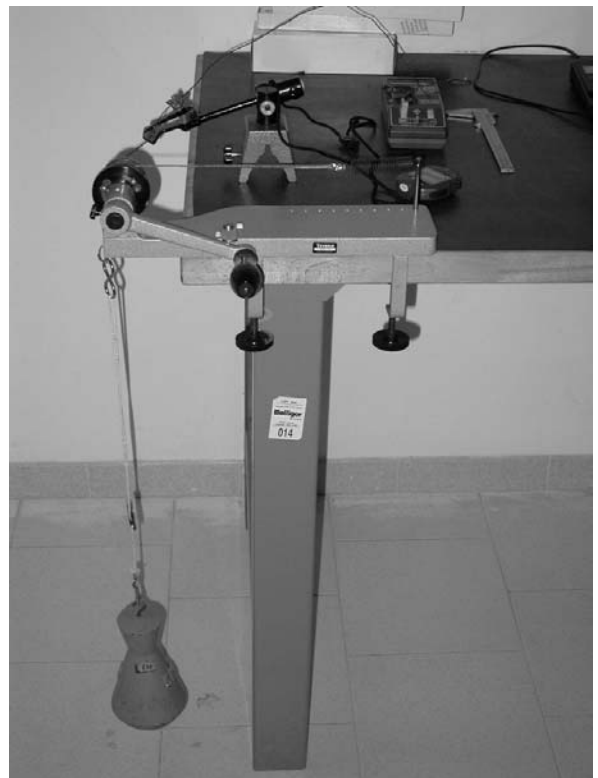
Figura 1 - Misura della costante di Joule
