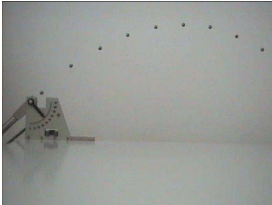
Fig. 1 Immagine fotografica della traiettoria parabolica di un proiettile, ottenuta sovrapponendo fotogrammi successivi acquisiti a 1/25 di secondo l'uno dall'altro.
