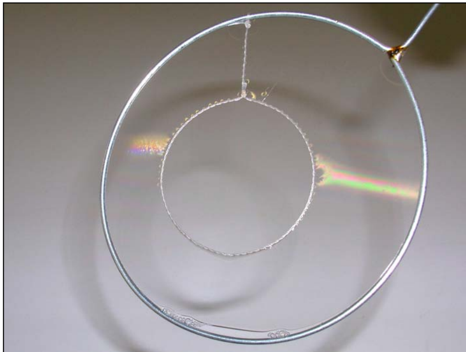
Fig. 4 Telaio metallico, con un sottile filo di cotone legato al contorno, immerso in una soluzione di sapone e glicerina in acqua. È visibile la lamina liquida che si estende fra il telaio metallico esterno e il cerchio interno.
